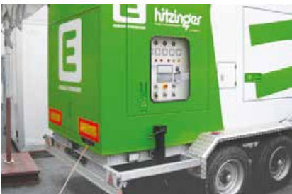
Yardımcı Güç Üniteleri / Auxiliary Power Unit for Locomotif
